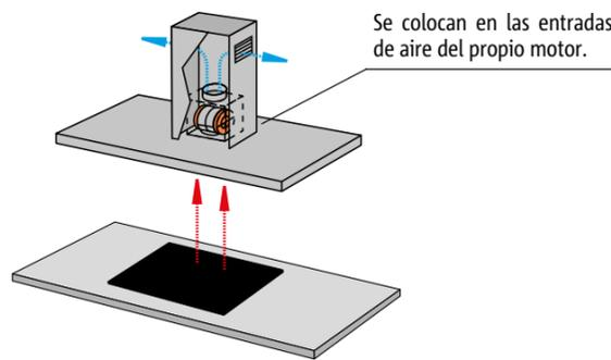
Se colocan en las entradas de aire del propio motor.
