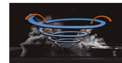
La Zona de aspiración de la Flow 5 gracias a su diseño, produce un flujo de aire de alta velocidad generando un efecto de atracción que se amplía a mayor altura atrayendo los humos hacia el centro y llevándolos hacia su interior.
