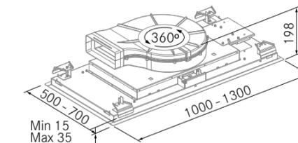
**Diseño técnico (Motores Exteriores)**
