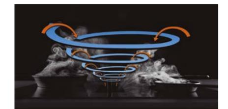
La Zona de aspiración de la Flow 5 gracias a su diseño, produce un flujo de aire de alta velocidad generando un efecto de atracción que se amplía a mayor altura atrayendo los humos hacia el centro y llevándolos hacia su interior.
