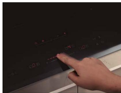
Rápida selección de la temperatura con el control deslizante: basta rozar el nivel de potencia deseado con un dedo en la pantalla táctil.
