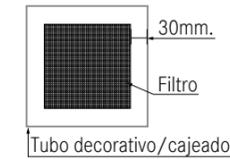
El filtro de carbón activo FC-Plus puede ser instalado a la salida del motor o puede ser instalado en diferido mediante un tubo rígido. Extrae el aire por todo su perímetro reduciendo así la fricción y la presión, por esta razón, para una buena circulación del aire a la salida de los filtros se recomienda dejar un mínimo de 30 mm. entre el filtro y el tubo decorativo o el cajead.
