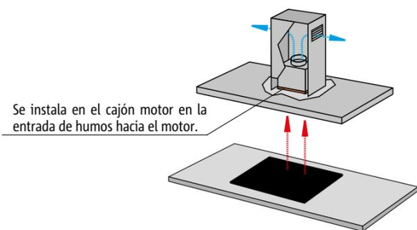
Se instala en el cajón motor en la entrada de humos hacia el motor.
