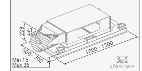
La campana Nitro 360 se instala a falso techo, para ello, debe poder soportar un peso de **30/35 kg.**
