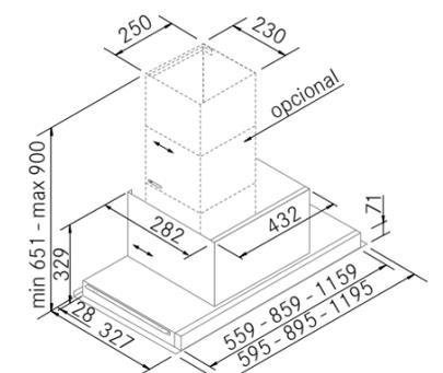
Tubo superior opcional no apto para plasma cilíndrico y FC-Plus
