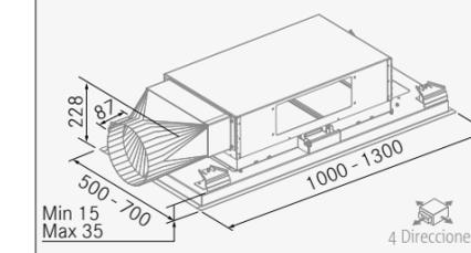
La campana SCL 360 se instala a falso techo, para ello, este debe poder soportar un peso de **30/35 kg.**
