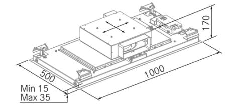
La campana TR9 Slim se instala a falso techo, para ello, debe poder soportar un peso de **30 kg**.
