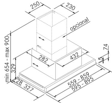
Tubo superior opcional no apto para plasma cilíndrico y FC-Plus
