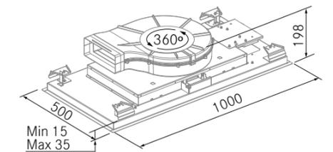
La campana Bright 360 se instala a falso techo, para ello, este debe poder soportar un peso de **30 kg.**
