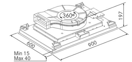
La campana Astro se instala a falso techo, para ello, este debe poder soportar un peso de **35 kg.**
