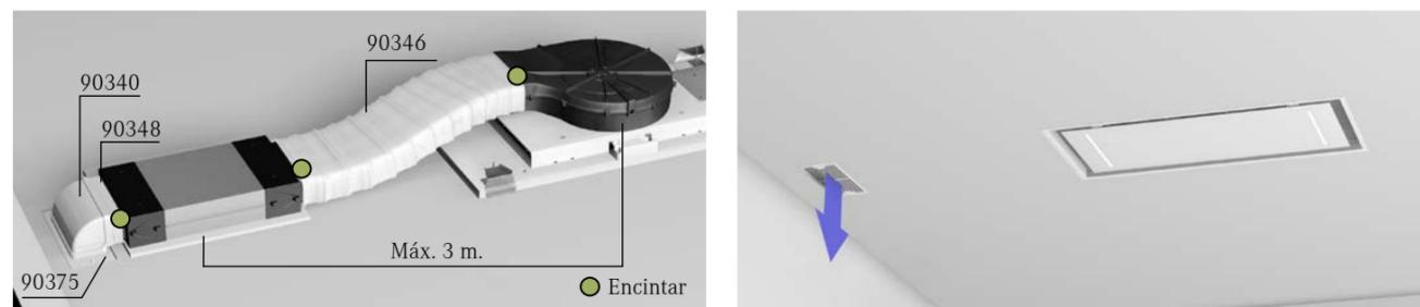
\* En función del grosor del falso techo y de la colocación de la rejilla será necesario alzar el filtro F800. Se recomienda algún material blando que absorba posibles vibraciones. IMPORTANTE: Es necesario dejar un registro en el techo para acceder al filtro y evitar tener que desmontar la campana en caso de avería de este.
