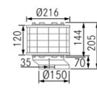
Los aparatos de Plasma redondos FRECAN extraen el aire por todo su perímetro reduciendo así la fricción y la presión, por esta razón, para una buena circulación del aire a la salida de los filtros de plasma se recomienda dejar un mínimo de 30 mm. entre el filtro y el tubo decorativo o el cajeadado.
