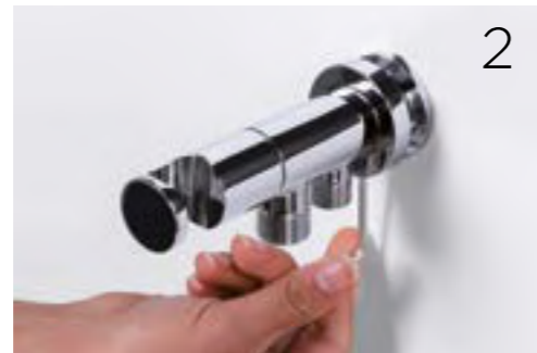
Fijar el cuerpo mediante el tornillo allen inferior.
