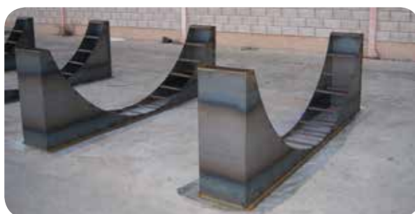
Patatas a hormigonar
