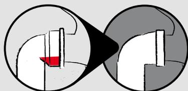
> DISEÑO "DESAGÜE +", SUPRIME LA RETENCIÓN DE AGUA EN LA SALIDA DEL WC Y ASÍ REDUCE EL RIESGO DE FUGAS.
