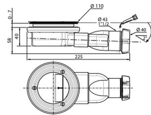
VÁLVULA EXTRAPLANA Ø90 SALIDA HORIZONTAL SLIM + SIN REJILLA PLATO DE DUCHA EXTRAPLANO
