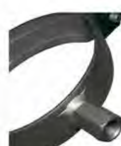
Cordón de soldadura a CO2 en 360°
