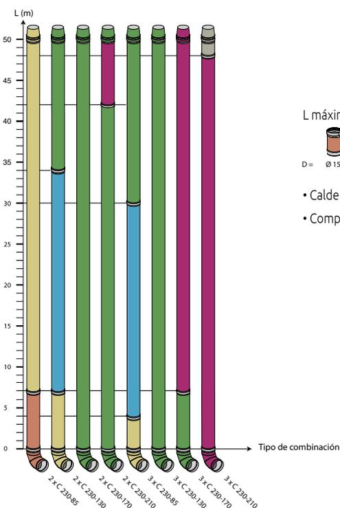
L máxima en función del diámetro del conducto D (en mm) para diferentes combinaciones de cascada C 230
