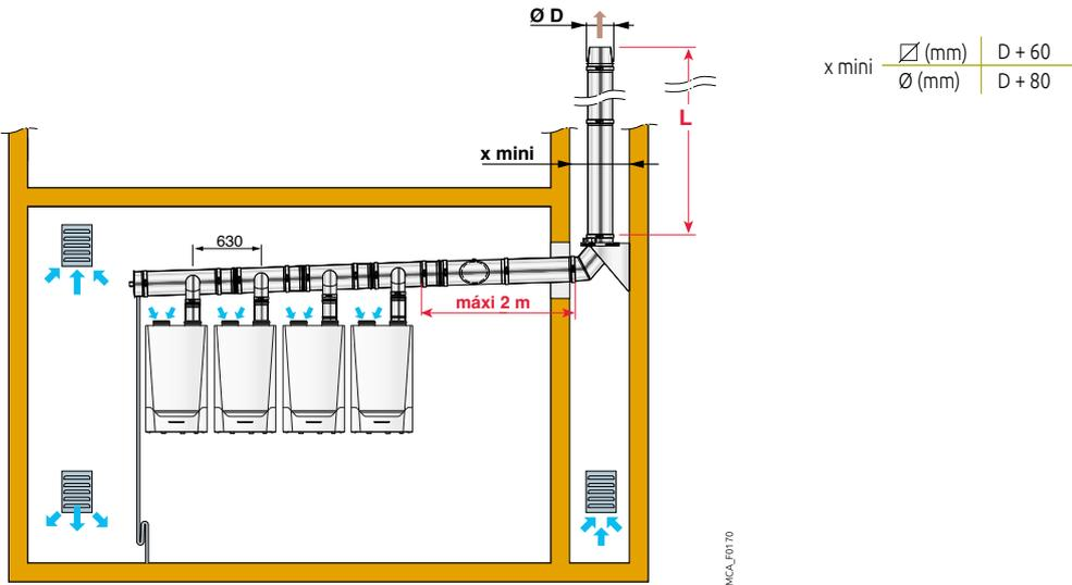
LONGITUD MÁXIMA L (EN m) ADMISIBLE EN FUNCION DEL DIÁMETRO DEL CONDUCTO D (EN mm) PARA DIFERENTES COMBINACIONES EN CASCADA
