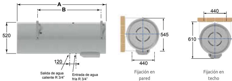
Los soportes se suministran con el termo eléctrico, fijación con 4 tornillos Ø 10 (no suministrados)
