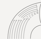
Representación del flujo de aire en un codo de 90° circular
