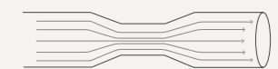
Representación del flujo de aire en un estrangulamiento del conducto de aire
