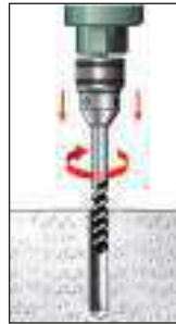
Taladrar con broca de 8 [mm]
