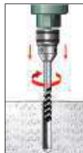
Taladrar con broca de 8 [mm]
