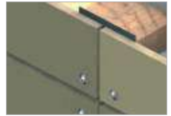
Fibrocemento sobre madera
