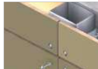
Fibrocemento sobre acero
