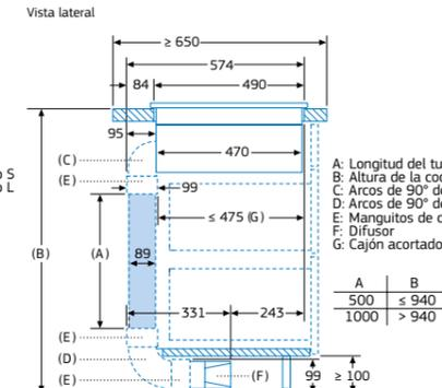
El instalador debe seleccionar y, en caso necesario, cortar la longitud del tubo de acuerdo con la altura de la cocina
