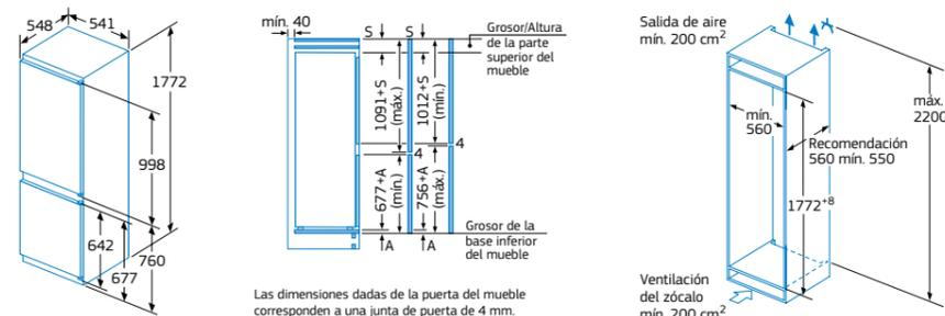
En caso de proceder a la instalación de dos combinados integrables juntos, es necesario dejar una distancia de separación de, al menos, 15 cm entre ellos.
