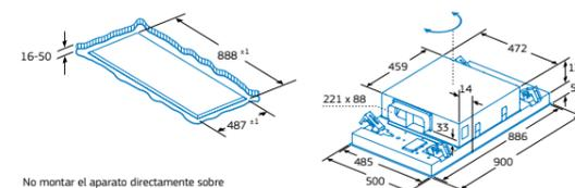
No montar el aparato directamente sobre tablas de yeso o materiales ligeros similares del falso techo. Se requiere una estructura inferior apta y que esté bien fijada al techo de hormigón.
