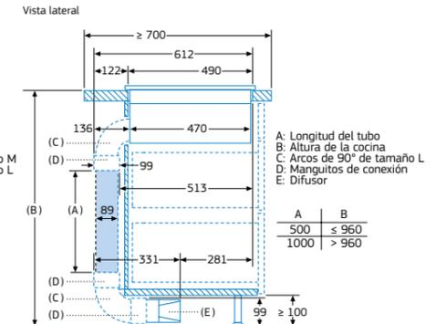
Kit conductos disponible para encimeras con profundidades de  $\geq 700$  mm y hasta 960 mm de altura
