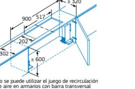
No se puede utilizar el juego de recirculación de aire en armarios con barra transversal (puerta abatible)
