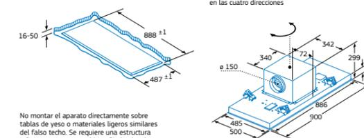
La salida del ventilador puede girarse en las cuatro direcciones
