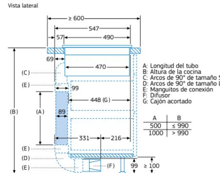
Kit conductos disponible para encimeras de  $\geq 600$  mm de profundidad y hasta 960 mm de altura
