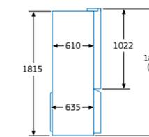
A: La parte frontal es ajustable desde 1830 hasta 1847, con las patas de nivelación totalmente extendidas
