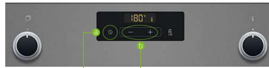
El sensor del reloj permite recorrer todos los ajustes básicos
