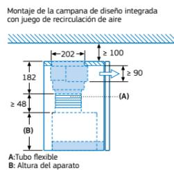
La combinación con una prolongación de chimenea requiere un panel intermedio para fijar el conducto superior
