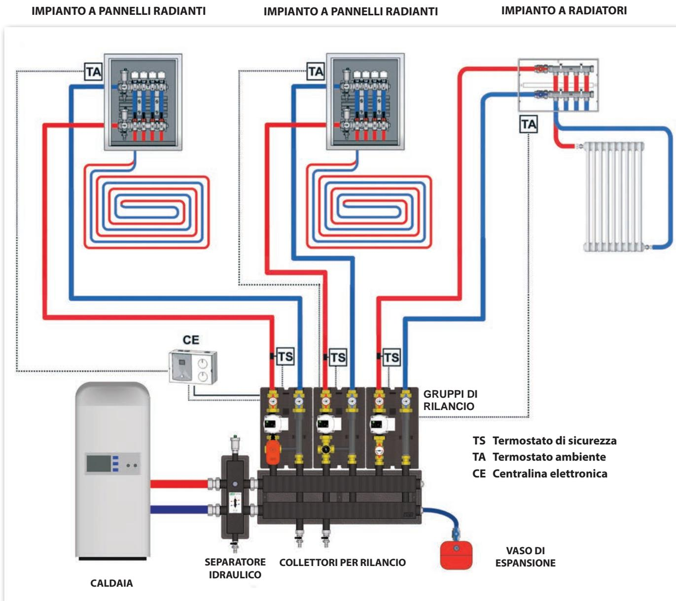
Ogni gruppo di rilancio è dotato di valvole di intercettazione complete di termometro e pozzetti, circolatore, tronchetto con valvola di ritegno e coibentazione.
