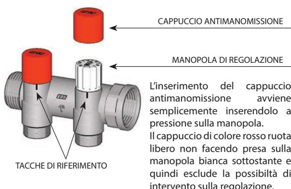
L'inserimento del cappuccio antimanomissione avviene semplicemente inserendolo a pressione sulla manopola. Il cappuccio di colore rosso ruota libero non facendo presa sulla manopola bianca sottostante e quindi esclude la possibilità di intervento sulla regolazione.
