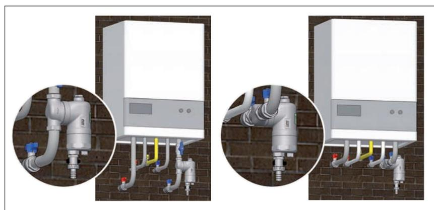
Il defangatore va posizionato sul circuito di ritorno prima dell'ingresso in caldaia, in modo tale da intercettare le impurità che potrebbero danneggiare la caldaia e i circolatori.
