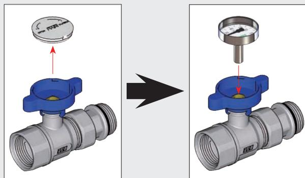
Le valvole con doppia calotta mobile permettono di posizionare la maniglia portatermometro orientata in base alle proprie esigenze. Una volta scelto l'orientamento è sufficiente avvitare le calotte alla tubazione.
