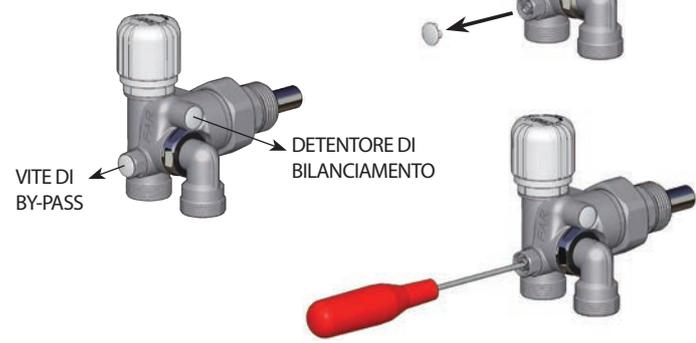
**Esempio d'installazione delle valvole mono-bitubo termostattizzabili con interasse variabile**
