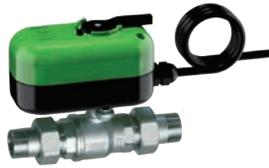
Valvola di zona a 2 vie cromata a sfera completa di codoli, calotte e servocomando elettrico con sblocco manuale con tensione di alimentazione 24V.
