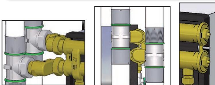
In altri tipi di impianti le colonne di distribuzione per la mandata del riscaldamento e di acqua calda sanitaria sono poste ad un lato della piastra mentre le colonne di ritorno del riscaldamento e dell'acqua fredda sanitaria sono poste sul lato opposto. In queste situazioni si può effettuare il collegamento con un raccordo eccentrico per la colonna più lontana ed un raccordo a tre pezzi diritto o a curva per la colonna più vicina.
