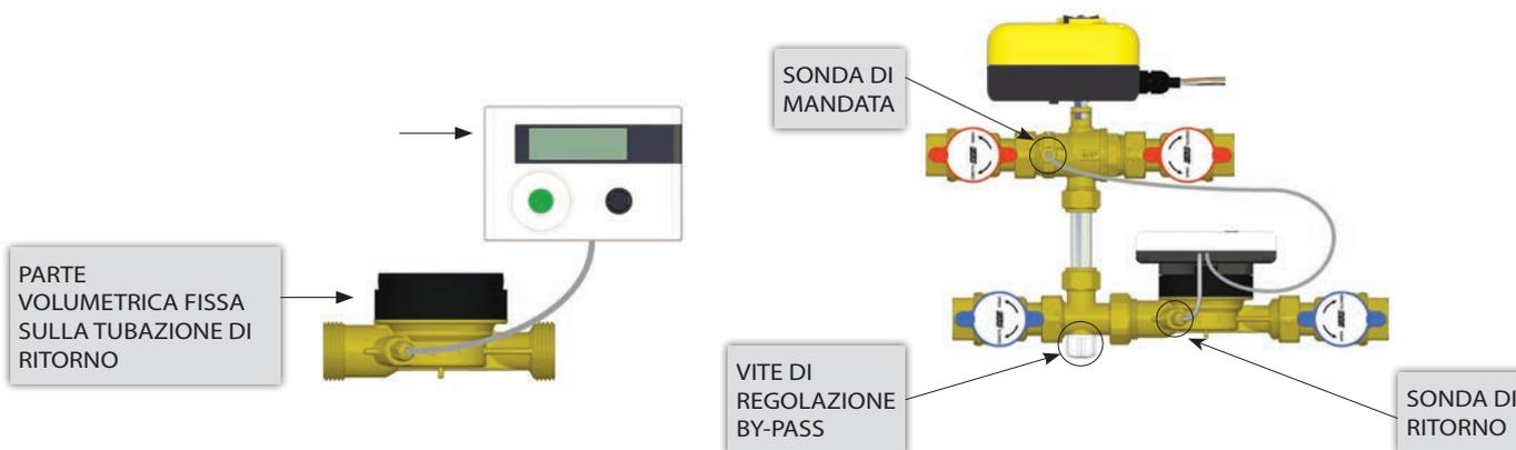
Il calorimetro FAR può essere installato in qualunque posizione e sempre sulla tubazione di ritorno. Il contenitore nel quale alloggia l'elettronica è orientabile a 360° e si può separare dal corpo del misuratore per facilitarne la lettura, nel caso di installazioni in nicchia o pozzetto. È disponibile nella versione caldo/freddo, in cui rileva il consumo di calorie e di frigorie, con display e tasto di funzione per la visualizzazione dei valori misurati.
