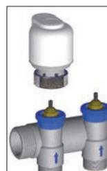
**Installazione comando elettrotermico**
