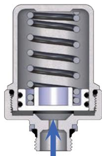
Il fenomeno del "colpo d'ariete" si manifesta in caso di improvvisa apertura e chiusura di un'utenza (rubinetto, miscelatore ecc.), attraverso la quale si generano delle sovrappressioni dannose all'interno dell'impianto.
