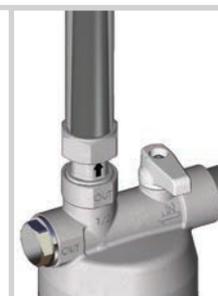
Grazie al raccordo con valvola di ritegno e alla valvola a sfera incorporata, il dosatore potrà essere isolato rapidamente dal circuito per effettuare la manutenzione o la sostituzione della cartuccia di polifosfati.
