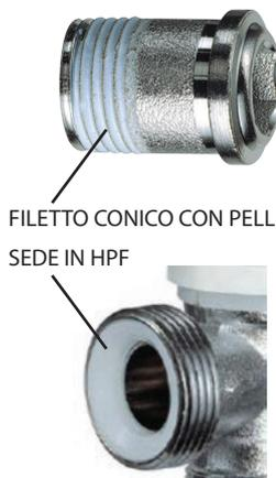
I codoli hanno filetto conico e in più sono preguarniti con una particolare pellicola morbida Loctite® Dri-Seal 5061 che garantisce la tenuta su filettature a norma.
