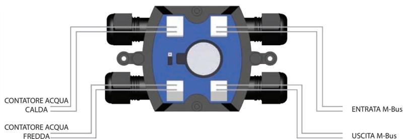
Per il cablaggio della rete M-Bus è necessario utilizzare un semplice cavo a 2 fili di sezione opportuna, twistato non schermato.
