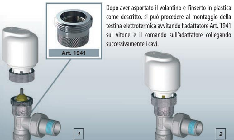
Dopo aver asportato il volantino e l'inserto in plastica come descritto, si può procedere al montaggio della testina elettrotermica avvitando l'adattatore Art. 1941 sul vitone e il comando sull'adattatore collegando successivamente i cavi.
