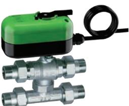
Valvola di zona a 3 vie cromata a sfera con tee di by-pass completa di codoli, calotte e servocomando elettrico con sblocco manuale con tensione di alimentazione 24V.
