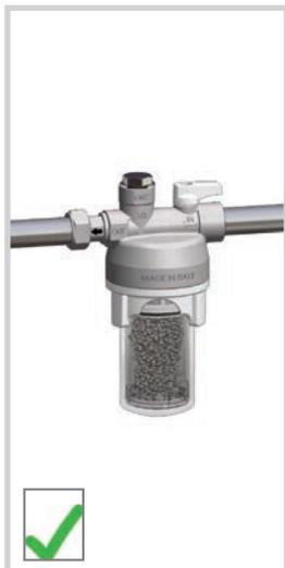
Il filtro dosatore di polifosfati PolyFAR deve essere installato sulla tubazione di acqua fredda a monte del generatore di acqua calda sanitaria (caldaia, scaldabagno, ecc.). Grazie al filtro a maglie in acciaio da 100 µm integrato, con il filtro dosatore PolyFAR non serve montare un ulteriore filtro di sicurezza a protezione del produttore di acqua calda sanitaria (come prescritto dalla norma UNI 8065).
