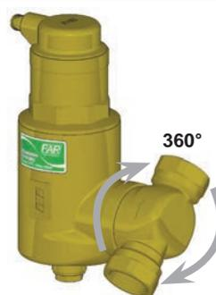
Il disaeratore orientabile è adatto all'installazione su tubazioni con disposizione verticale ed orizzontale in quanto la parte con gli attacchi filettati può ruotare di 360° attorno al proprio asse.
