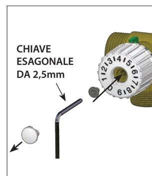
Il collettore con valvola di bilanciamento è adatto per impianti di riscaldamento o raffrescamento in cui vi è la necessità di regolare l'alimentazione di ventilconvettori o termoconvettori posti in ambienti diversi, riuscendo a gestire in maniera ottimale il flusso di acqua per ogni derivazione.
