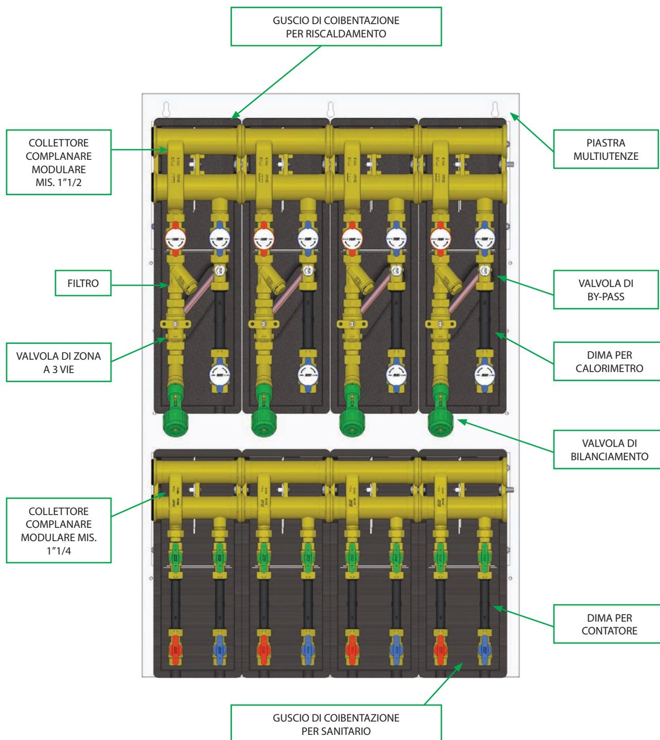
Ogni utenza, sia per il sanitario, sia per il riscaldamento, è prevista di valvole di intercettazione a monte ed a valle per eventuali operazioni di manutenzione o sostituzione dei componenti.
