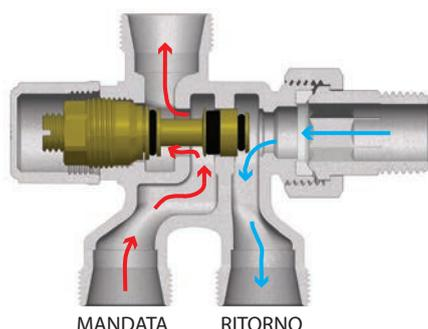
La taratura del detentore, tramite una chiave a brugola del 5 o un cacciavite piatto, permette di regolare il flusso d'acqua al radiatore. In figura è illustrato l'andamento dei flussi in condizioni di valvola aperta. Chiudendo il detentore non vi è il passaggio di acqua all'interno del radiatore.
