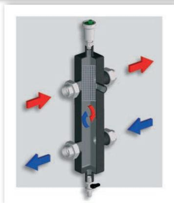
Nel disegno è riportata la sezione del separatore dove è visibile, all'interno, la griglia forata.
