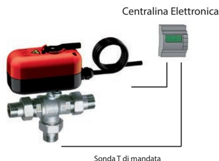
Una centralina elettronica opportunamente collegata al servocomando provvede, tramite il segnale di una sonda di temperatura installata all'uscita della valvola, a regolare la posizione della sfera al fine di ottenere il fluido miscelato alla temperatura desiderata.
