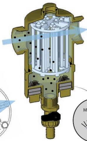
Come si può osservare nelle figure, la presenza delle barre verticali serve ad occupare nella direzione del fluido più spazio possibile, in modo da garantire un impatto frontale per la particella di impurità trasportata dal fluido.
