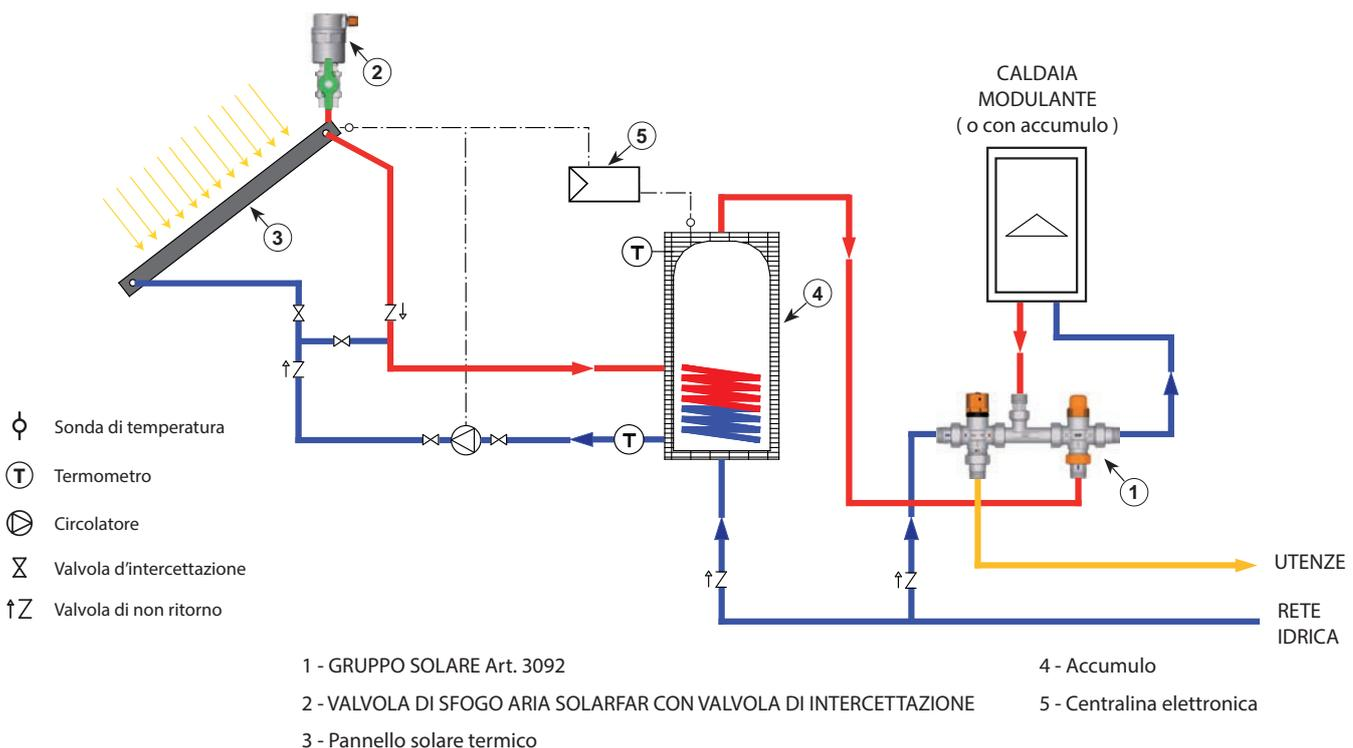
Valvola automatica sfogo aria con scarico in posizione orizzontale per impianti solari.
