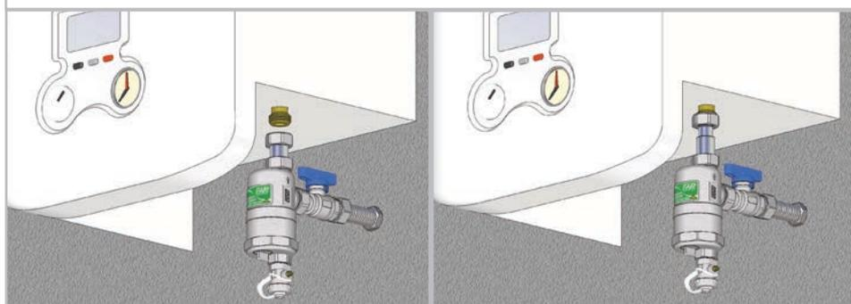
Esempio d'installazione Art. 5304 su defangatore COMPACTFAR, posizionato sotto caldaia
