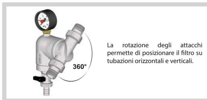
L'acqua in ingresso segue un percorso guidato ed entra nella rete filtrante dall'alto per poi spostarsi in direzione radiale e liberarsi delle impurità. Le particelle così si attaccano alla rete, oppure cadono verso il basso accumulandosi in prossimità del rubinetto di scarico.
