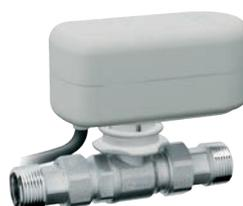
Valvola di zona a 2 vie cromata a sfera con aggancio rapido completa di codoli, calotte e servocomando elettrico con tensione di alimentazione 24V.
