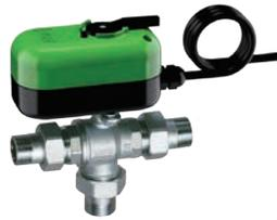
Valvola di zona deviatrice a 3 vie cromata a sfera completa di codoli, calotte e servocomando elettrico con sblocco manuale con tensione 24V.
