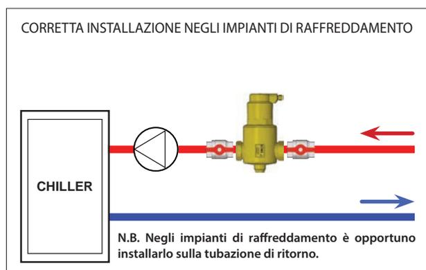
Nel caso si verificano perdite dalla valvola di sfogo aria occorre pulirla o sostituirla procedendo in questo modo: rimuovere completamente il cappuccio e con l'aiuto di una chiave a brugola da 4mm svitare la valvolina di sfogo per poi procedere con la pulizia o la sostituzione (Fig.1). Per il corretto inserimento dell'asta sul galleggiante, riavvitare come illustrato in Fig.2, con il corpo superiore del disaeratore sottosopra e la valvolina orizzontale.
