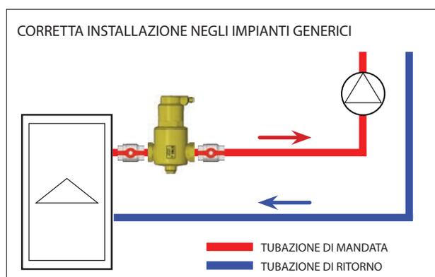
È possibile ruotare la valvola di sfogo aria di 360° e indirizzare così lo scarico dove risulta più opportuno, senza dover arrestare l'impianto.
