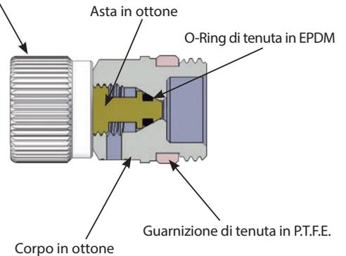
GAISER - Valvola sfogo aria con scarico in posizione orizzontale. Fornita con guarnizione premontata alla base del filetto per facilitarne l'installazione.
