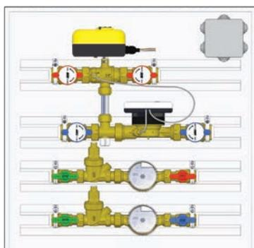
Riduttore di pressione giallo per impianti idrosanitari.
