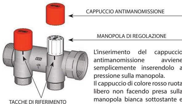
L'inserimento del cappuccio antimanomissione avviene semplicemente inserendolo a pressione sulla manopola. Il cappuccio di colore rosso ruota libero non facendo presa sulla manopola bianca sottostante e quindi esclude la possibilità di intervento sulla regolazione.
