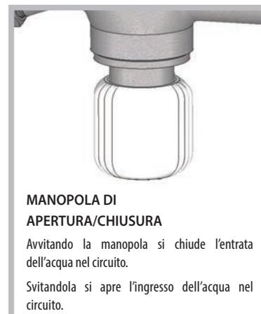
Una volta effettuato il riempimento e la taratura della pressione dell'impianto chiudere la manopola di apertura/chiusura. Nel caso di abbassamento di pressione di esercizio, riaprire la manopola di apertura/chiusura e l'impianto verrà riportato automaticamente alla pressione di taratura impostata inizialmente.
