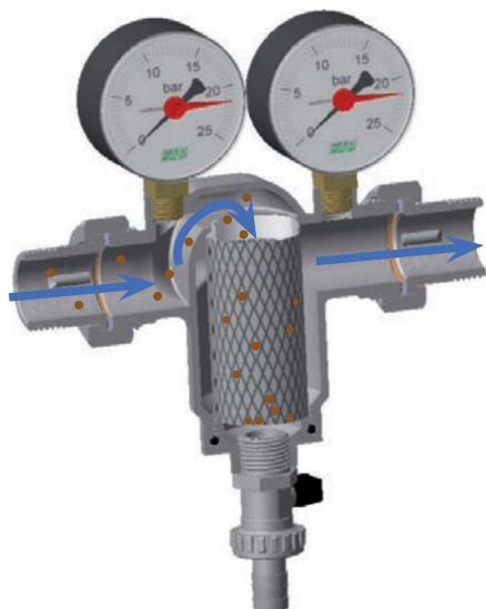
Il filtro inclinato FAR è un componente idraulico di dimensioni contenute che permette l'eliminazione d'impurità e particelle che possono inquinare l'impianto e danneggiare i componenti all'interno di esso. La cartuccia filtrante contenuta all'interno è facilmente asportabile per una semplice e veloce manutenzione o sostituzione.
