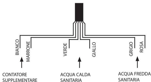
Per il collegamento di soli contatori acqua alla rete M-Bus è necessario acquistare l'adattatore impulsi Art. 2342. Questo strumento serve per convertire gli impulsi provenienti dai contatori di acqua sanitaria in segnali compatibili con il sistema M-Bus. L'adattatore impulsi è dotato di 2 ingressi per i contatori, un ingresso ed un'uscita per la rete M-Bus.
