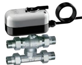
Valvola di zona a 3 vie cromata a sfera con tee di by-pass completa di codoli, calotte e servocomando elettrico con sblocco manuale con tensione di alimentazione 24V.
