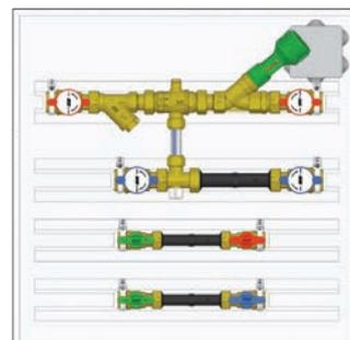
Le cassette prevedono di serie l'ingresso del fluido a sinistra. Qualora il sistema prevedesse l'ingresso del fluido a destra occorre ribaltare gli strumenti e successivamente ruotare di 180° le valvole a sfera.
