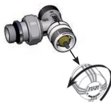
1. Svitare completamente il volantino ruotandolo in senso antiorario.
