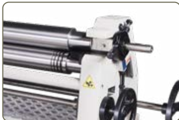
▶ Desbloqueo manual estandar con sensor de seguridad
