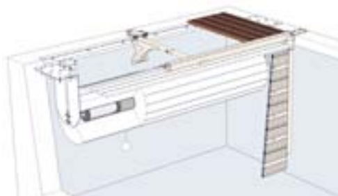
Roussillon motor en el eje fijación bajo piedra de coronación
